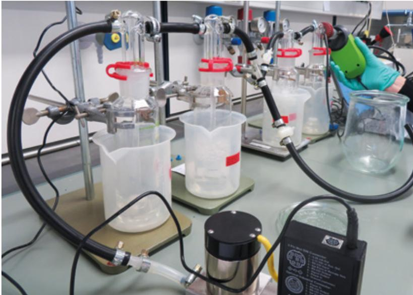
Messung der Prüfkeimlösung mit dem *airco well*® Sensor
