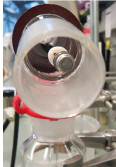
Glasaufsatz mit integriertem 3-Schicht Sensor
